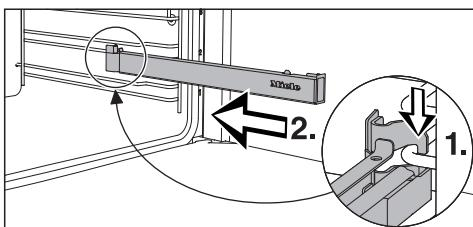
■ Зашептите телескопическую направляющую FlexiClip передней частью за нижнюю опору одного уровня (1.) и задвиньте ее вдоль опоры в рабочую камеру (2.).
