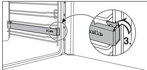
■ Зафиксируйте телескопическую направляющую FlexiClip на нижней опоре уровня (3.).
