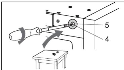
13. С противоположной стороны от верхнего шарнира установите крышку (5) и прикрутите с помощью винта (4).
