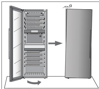
Если дверь не выровнена с корпусом (угол  $\alpha$  не равен  $0^\circ$ ),
