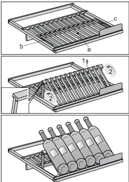
Наклонная полка для бутылок позволяет хранить бутылки в двух положениях: горизонтально или под наклоном. Поднимите (1) переднюю часть полки (а) и зафиксируйте в поднятом положении с помощью поворотных (2) боковых опор (b, c). В передней части полки можно разместить до 6 бордоских бутылок.
