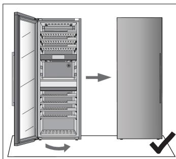
15. Закройте дверь и проверьте, чтобы она была выровнена с корпусом. Края корпуса и двери должны быть параллельны.
