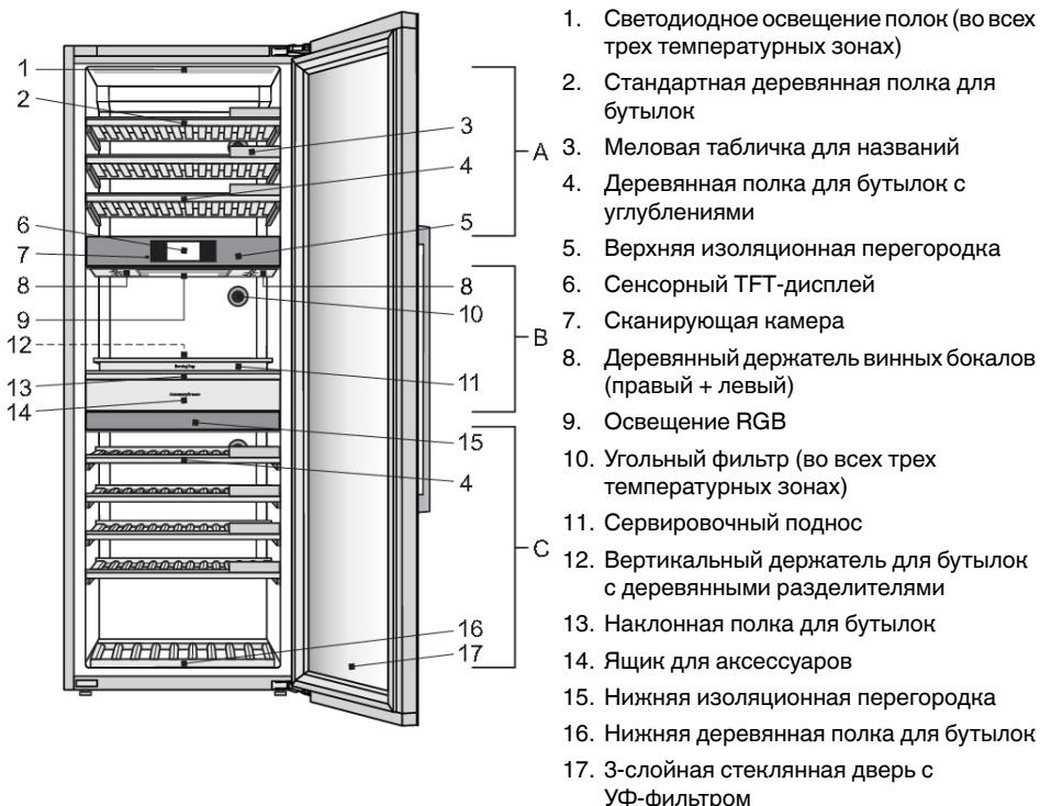
Внутри винного климатического шкафа установлены две изоляционные перегородки: верхняя изоляционная перегородка (5) и нижняя изоляционная перегородка (15). Таким образом, внутреннее пространство винного климатического шкафа разделено на три температурные зоны: А, В (зона подачи) и С. Это позволяет хранить и быстро подавать различные виды вина.
