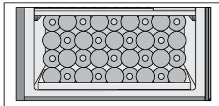
Нижняя деревянная полка предназначена для хранения бутылок в зоне компрессора. Это отделение подходит для длительного хранения вина, особенно предназначенного для созревания без чрезмерной вибрации и лишних перемещений. На нижней деревянной полке можно разместить до 36 бордоских бутылок (0,75 литра).
