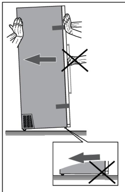
При перемещении не толкайте прибор, так как это может привести к его повреждению. Снизу в задней части прибора расположены два колесика, которые облегчают перемещение.
