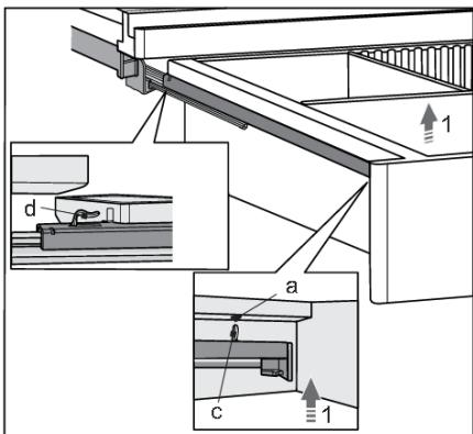
Ящик можно извлекать из прибора, не снимая сервировочную полку с направляющими. Для этого полностью выдвиньте ящик, поднимите его спереди (1) и потяните на себя.
