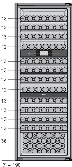
Комплект полок позволяет изменять конфигурацию прибора, и при такой конфигурации в приборе можно хранить 190 бордосских бутылок.
