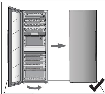
4. Отрегулируйте положение двери так, чтобы края двери и корпуса были параллельны.
