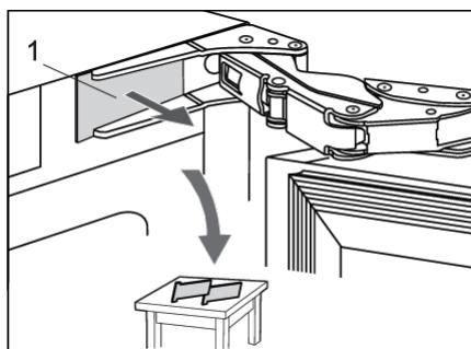
2. Снимите крышки (1) с верхнего и нижнего шарниров. Отложите в сторону, так как они понадобятся позже.
