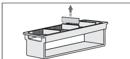
Вертикальный держатель для бутылок с деревянными разделителями (12) предназначен для хранения бутылок в вертикальном положении. Деревянные разделители можно вставлять в пазы на разном расстоянии, чтобы создавать отдельные отсеки для бутылок.
