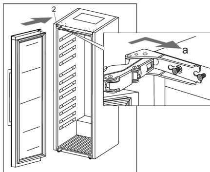
10. Навесьте дверь на винты (2) в верхней и нижней части и сдвиньте ее в направлении стрелки (а).
