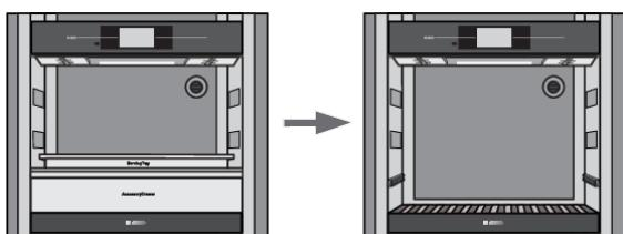
Извлеките элементы сервисного комплекта в указанном порядке: вертикальный держатель для бутылок, сервисный поднос и наклонная полка для бутылок с ящиком для аксессуаров. Процедура извлечения каждого элемента сервисного комплекта описана в разделе «Зона В: зона подачи».
