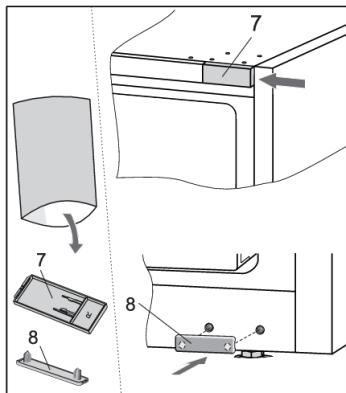
14. Возьмите крышки (7 и 8) из пакета с инструкцией по эксплуатации и установите их на стороне, противоположной от шарниров.
