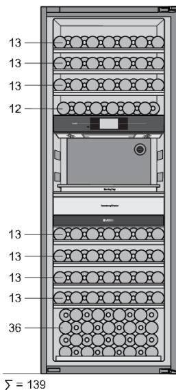
Стандартная конфигурация прибора позволяет хранить до 139 бордоских бутылок.
