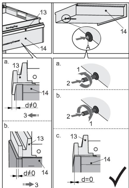
Если наклонная полка для бутылок (13) и ящик для аксессуаров (14) не выровнены спереди ( $d \neq 0$ ), сначала полностью выдвиньте ящик, чтобы получить доступ к механизму открывания ящика на его задней стенке. Нажмите на регулятор (A), чтобы освободить механизм. Вращайте регулятор, чтобы отрегулировать его длину.
