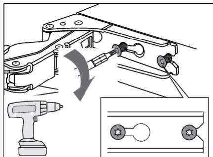
11. Затяните винты. Винты должны быть затянуты с моментом затяжки 6,2 Нм.
