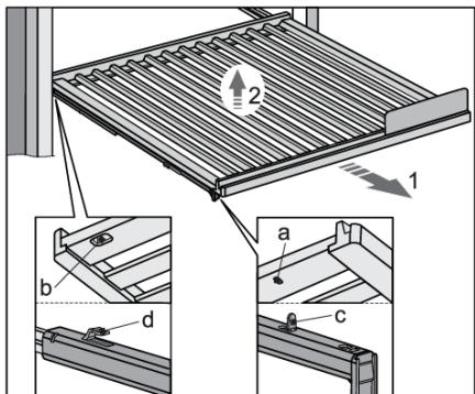
Чтобы извлечь полку из прибора, полностью выдвиньте телескопические направляющие (1), затем поднимите полку вверх (2) и снимите с направляющих. Следите, чтобы не повредить уплотнитель двери.
