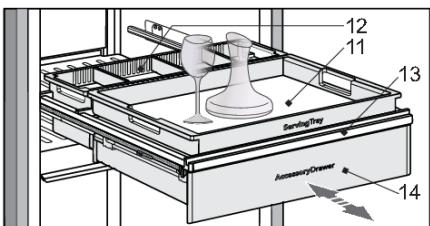
Ящик для аксессуаров (14) установлен на телескопических направляющих с полным выдвижением. Для открывания используется нажимной механизм. Нажмите на закрытый ящик, чтобы полностью открыть его. Чтобы закрыть ящик, снова нажмите на его переднюю панель.
