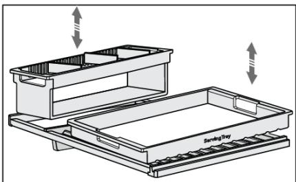
Наклонная полка для бутылок (13) установлена на телескопических направляющих с полным выдвижением и доводчиком и имеет защиту от опрокидывания. Сервировочный поднос размещается в передней части сервировочной полки, вертикальный держатель для бутылок вставляется в заднюю часть полки. Поднос и держатель для бутылок можно снимать с полки и извлекать из прибора (для обслуживания вне винного климатического шкафа; обслуживание или очистка).
