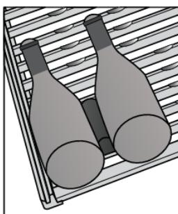
В некоторых случаях, если бутылки неправильно размещены или не зафиксированы, то они могут перемещаться во время открывания или закрывания полки. Во избежание перемещения рекомендуется использовать ограничитель для бутылок (A), который входит в комплект поставки прибора.
