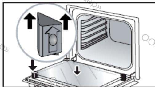
После очистки снова установите четыре резиновых соединительных стойки стрелкой вверх и поставьте на место стеклянный блок.
