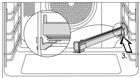
■ Сдвиньте телескопическую направляющую FlexiClip по диагонали вдоль верхней опоры назад до упора (3).
