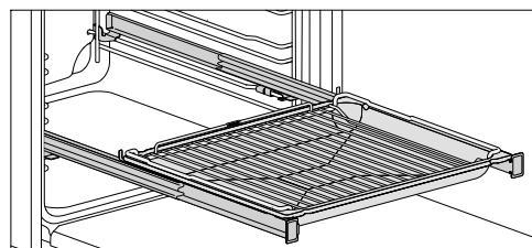
■ Задвигните универсальный противень с лежащей на нём решёткой для выпечки и запекания на телескопические направляющие FlexiClip. При задвигании решётка для выпечки и запекания автоматически скользит между опорами над телескопическими направляющими FlexiClip.
