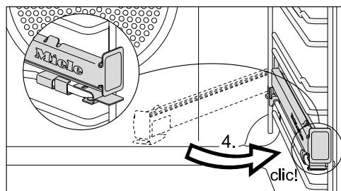
■ Отведите телескопическую направляющую FlexiClip назад и зафиксируйте её на верхней опоре до слышимого щелчка (4).
