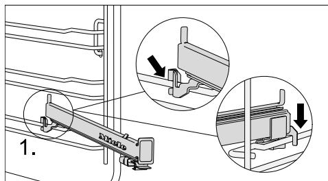
■ Зафиксируйте телескопическую направляющую FlexiClip спереди на верхней опоре уровня (1).
