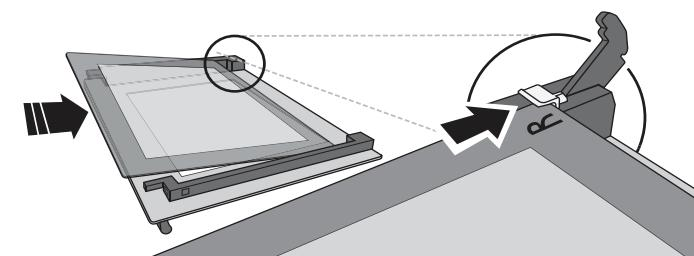
4. Montați la loc marginea superioară: Poziționarea corectă se realizează după ce se audă un clic. Asigurați-vă că garnitura este fixată sigur înainte de a remonta ușa.
