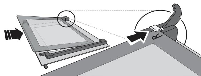
4. Zamontować ponownie górną krawędź: charakterystyczne kliknięcie sygnalizuje prawidłową pozycję. Przed ponownym założeniem drzwiczek należy sprawdzić, czy uszczelka jest zabezpieczona.
