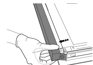
2. Das Innenglas mit beiden Händen anheben und fest halten, es entfernen und auf eine weiche Fläche legen, um es daraufhin zu reinigen.
