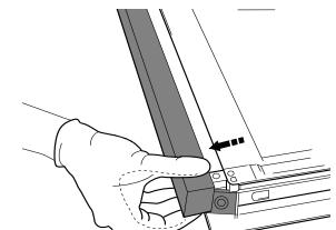
2. Levante e segure firmemente o vidro interior com ambas as mãos, removendo-o e colocando-o sobre uma superfície suave antes de proceder à sua limpeza.
