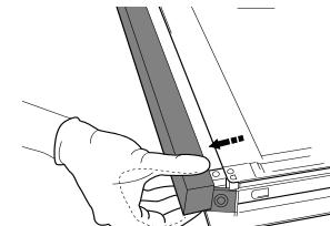
2. Sollevare e prendere saldamente il vetro interno con due mani, rimuoverlo e appoggiarlo su un piano morbido prima di eseguire la pulizia.
