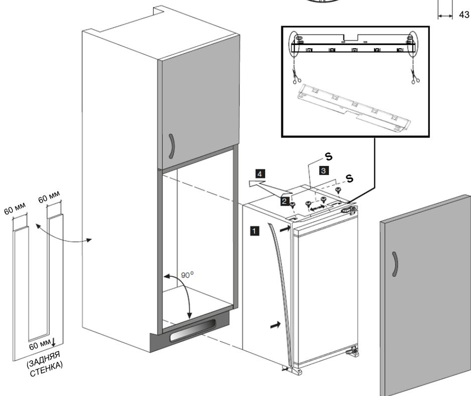
**Примечание:** на шаге 2 не следует сильно затягивать винты, которыми крепится верхняя пластмассовая деталь, чтобы при необходимости её легко можно было сдвинуть влево или вправо. Перед тем, как установить на холодильник пластмассовую деталь, срежьте выступающую часть слева или справа, на одной стороне с петлями (как показано на иллюстрации).
