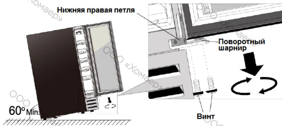
2. Аккуратно снимите дверцу с верхней правой петли; будьте осторожны, чтобы не поцарапать ее. Вытащите поворотный шарнир из отверстия для дверной петли.
