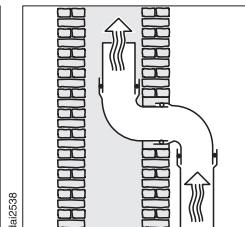
Если вытяжной канал отводится в вентиляционную трубу, то входной штуцер должен быть направлен в сторону потока воздуха.
