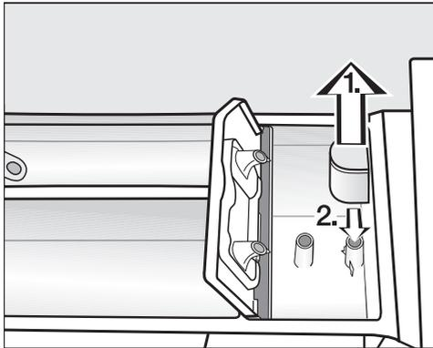
1. Retirez le tube d'aspiration de son logement ☼ et nettoyez-le à l'eau chaude. Nettoyez également le tuyau sur lequel le tube d'aspiration est fixé.
