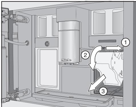
■ Извлеките заварной механизм, потянув его сначала в сторону ①, затем вперёд ②. При этом наклоните заварной механизм вперёд ③.
