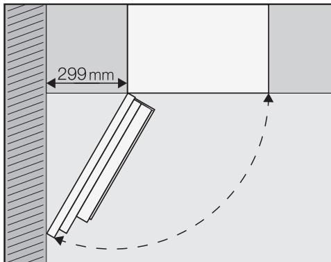
Проверьте, имеется ли между стеной или т.п. слева от кофемашины расстояние минимум 299 мм, чтобы вы могли достаточно широко открывать дверцу и вынимать левый контейнер для кофейных зёрен (угол открывания дверцы минимум 120°).
