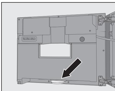
Внизу на внутренней стороне дверцы прибора находится лоток для сбора капель.
