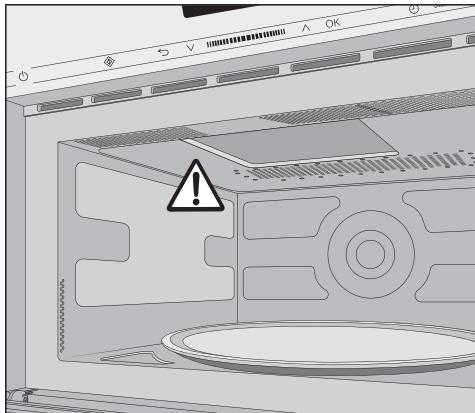
Не удаляйте специальную защитную пластины, расположенную в рабочей камере перед отверстием выхода микроволн.
