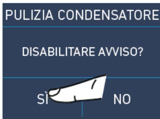
**F)** E' possibile disattivare il segnale di avviso e visualizzare il tempo residuo per la prossima pulizia toccando il tasto **Sì**.
