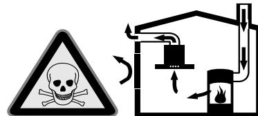
Raumluftabhängige Feuerstätten (z.B. gas-, öl-, holz- oder kohlebetriebene Heizgeräte, Durchlauferhitzer, Warmwasserbereiter) beziehen Verbrennungsluft aus dem Aufstellraum und führen die Abgase durch eine Abgasanlage (z.B. Kamin) ins Freie. In Verbindung mit einer eingeschalteten Dunstabzugshaube wird der Küche und den benachbarten Räumen Raumluft entzogen - ohne ausreichende Zuluft entsteht ein Unterdruck. Giftige Gase aus dem Kamin oder Abzugsschacht werden in die Wohnräume zurückgesaugt.
