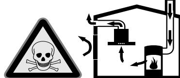
Vuurbronnen die de lucht in de ruimte verbruiken (bijv. apparaten die op gas, olie, hout of kolen worden gestookt, geisers, warmwatertoestellen) trekken de verbrandingslucht uit de opstellingsruimte en voeren de gassen via een afvoer (bijv. schoorsteen) af naar buiten.
