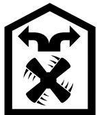
L'air aspiré se nettoie en traversant les filtres à graisse et un filtre au charbon actif, puis il revient dans la cuisine.
