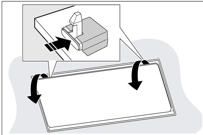
**2** Filterabdeckung vollständig und ohne Zug öffnen.
