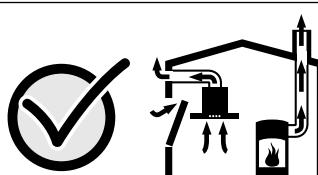
Raadpleeg in ieder geval het bedrijf dat in uw huis zorgt voor de schoorsteenreiniging. Dit bedrijf is in staat het totale ventilatiesysteem van uw huis te beoordelen en kan een voorstel doen voor passende maatregelen op het gebied van de luchttoevoer.
