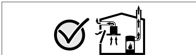
Ziehen Sie in jedem Fall den Rat des zuständigen Schornsteinfegermeisters hinzu, der den gesamten Lüftungsverbund des Hauses beurteilen kann und Ihnen die passende Maßnahme zur Belüftung vorschlägt. Wird die Dunstabzugshaube ausschließlich im Umluftbetrieb eingesetzt, ist der Betrieb ohne Einschränkung möglich.
