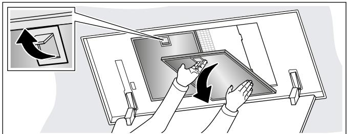
**4** Metallfettfilter aus der Halterung herausnehmen.
