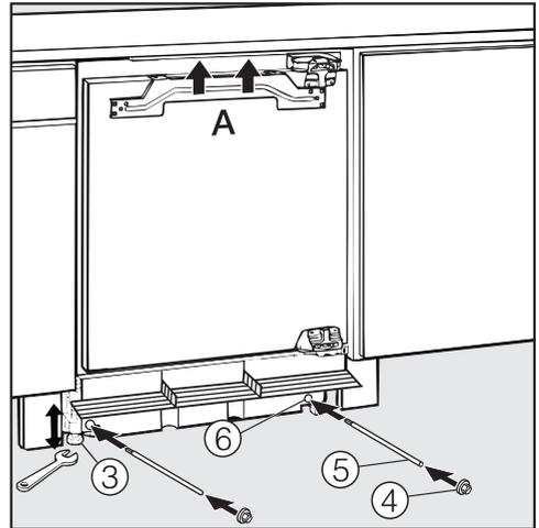
Nun wird das Kältegerät über die vorderen und hinteren Stellfüße ausgerichtet, bis die Oberseite des Kältegerät an der Arbeitsplatte anliegt (A).
