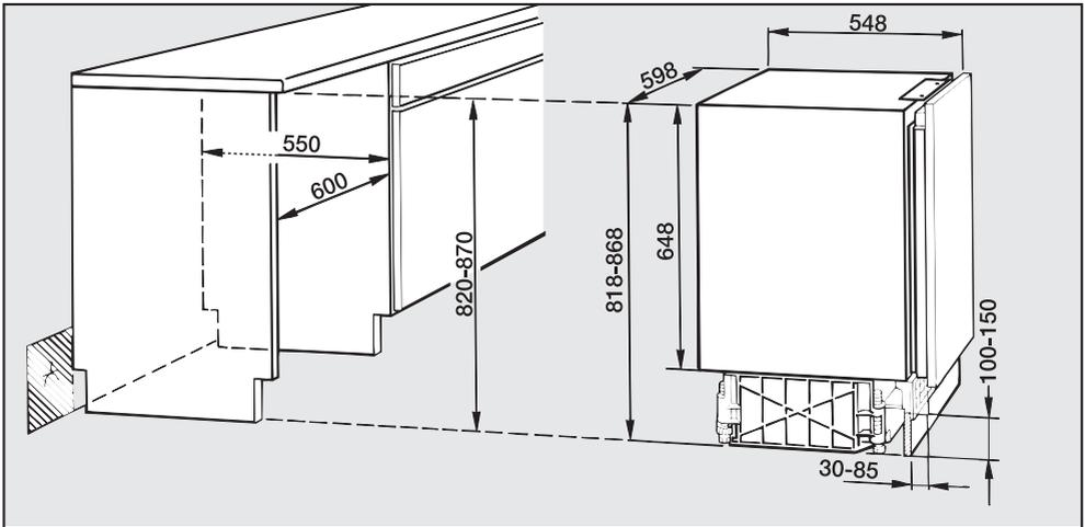
Bei einer **Unterbauhöhe von 820 mm** kann die Sockelblende **100 – 170 mm** hoch sein. Bei einer Höhe von genau 100 mm kann die Sockelblende unverändert montiert werden. Bei einer Höhe von  $> 100$  mm muss die Sockelblende für die Be- und Entlüftung ausgeschnitten werden (siehe Kapitel „Installation“, Abschnitt „Kältegerät unterbauen“).
