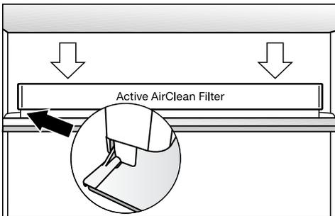
Die Halterung des Geruchsfilters wird auf die hintere Schutzleiste der Abstellfläche gesteckt und kann beliebig versetzt werden.
