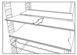
Слегка приподнимите переднюю половину стеклянной полки и осторожно сдвиньте стеклянную полку под заднюю половину.
