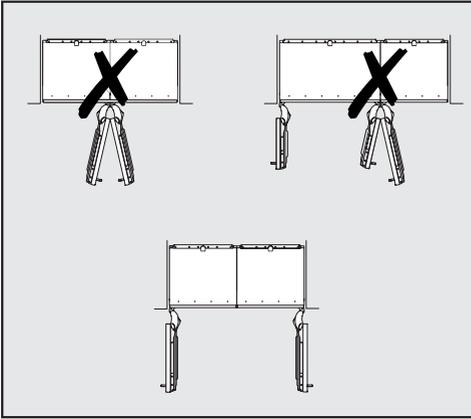
Falls sich zwischen den nebeneinander aufgestellten Kältegeräten keine Zwischenwand befindet, müssen die Kältegeräte mit Hilfe des Side-by-Side Montagekits miteinander verbunden werden. Zusätzlich muss die Seitenwandheizung installiert werden, um die Bildung von Kondenswasser und eventuell daraus resultierende Folgeschäden zu vermeiden.
