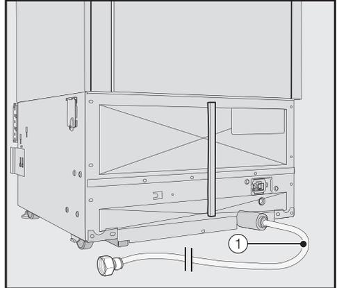
Der Edelstahlschlauch ① des Kältegeräts liegt anschlussfertig auf der Rückseite des Kältegeräts bereit.
