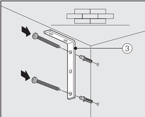
Befestigung an einer Betonwand
