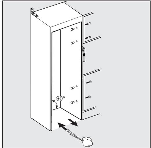
Vor Einbau des Kältegeräts die Einbaunische sorgfältig mit einer Wasserwaage ausrichten. Die Nischenecken müssen im 90°-Winkel zueinanderstehen, da sonst die Möbelfront nicht an allen 4 Ecken der Einbaunische anliegt.
