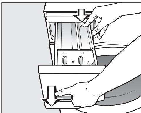
■ Выдвиньте отсек для моющих средств и добавок до упора, нажмите на кнопку открывания и извлеките отсек.
