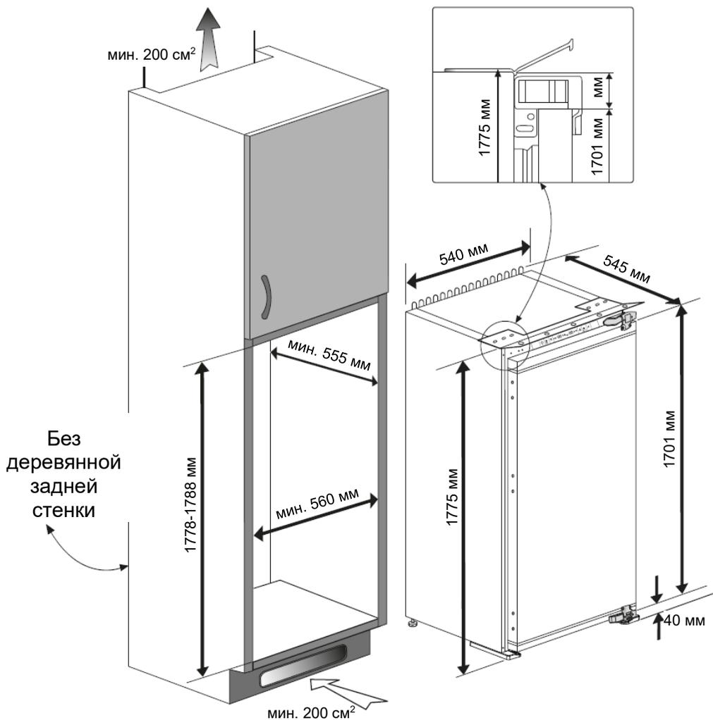
Задняя сторона кухонного шкафа должна быть полностью открыта по направлению к стене кухни; это необходимо для обеспечения достаточной циркуляции воздуха, охлаждающего конденсатор, и для сокращения расхода электроэнергии.
